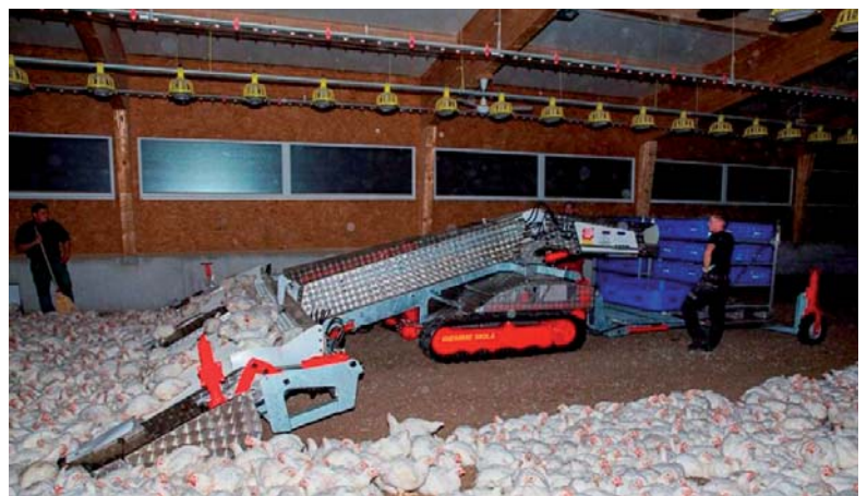
Photos: La machine de chargement de Thurtechnik AG en service. Les poulets montent d'eux-mêmes et sans stress sur le tapis de chargement (photo de gauche). Les animaux se trouvant à côté de la machine restent calmes et assis sans bouger. (Photos: Peter Röthlisberger)
